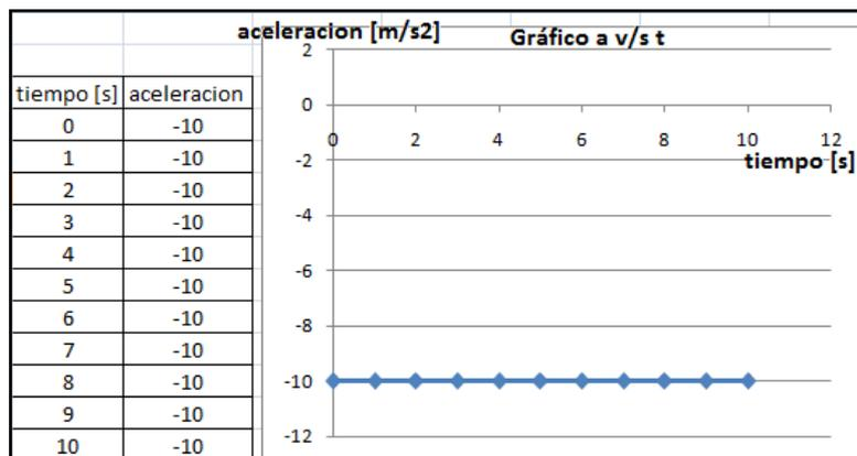
Una observación importante en este grafico que podemos anotar es que el área bajo la curva corresponde al valor de la variación de la velocidad del cuerpo, ya que  $\Delta V = a\Delta t$ . Recuerde la metodología del cálculo del área de un rectángulo en el caso del grafico V v/s t del MRU.
